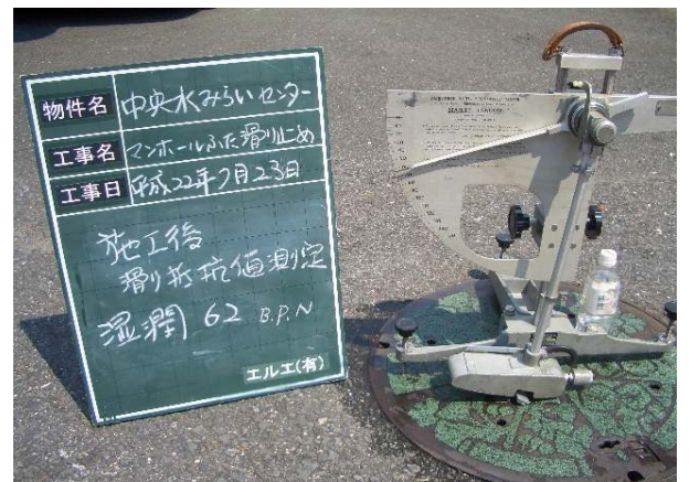
湿潤時 施工後 マンホール蓋・B.P.N 62
