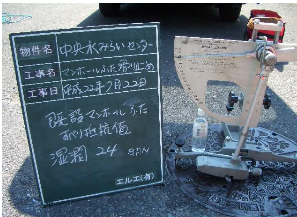
湿潤時 既設 マンホール蓋・B.P.N 24
