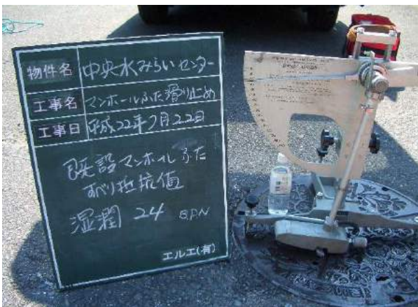
湿潤時既設マンホール蓋・B.P.N 24
